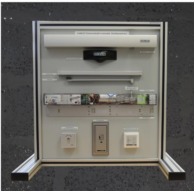
oben: Tischmodell einer Tür als Sonderausführung in pulverbeschichtetem Stahl mit Fallriegelschloss, Obentürschließer und einem Anbaufeld auf dem verschiedene Komponenten wie elektr. Türöffner, Feststellanlage, Rauchmelderzentrale, Codeschloss f. Zutrittskontrolle montiert sind.
