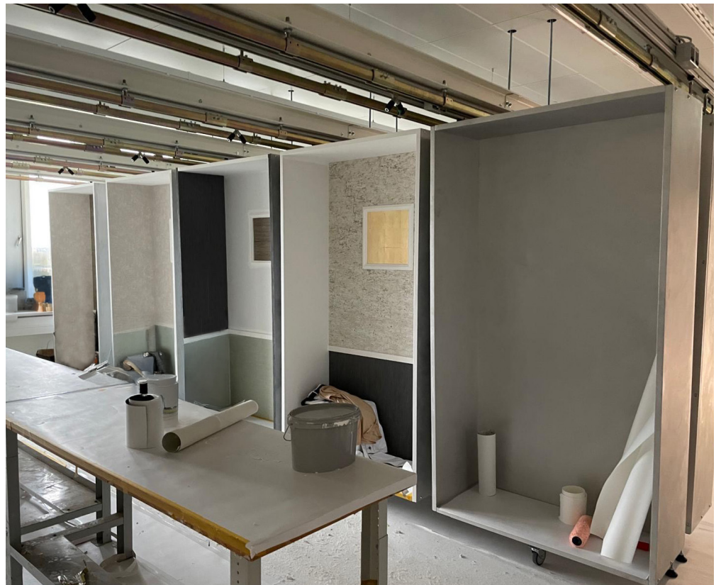
Standard Malerübungskabinen im Decken-Laufschienensystem
