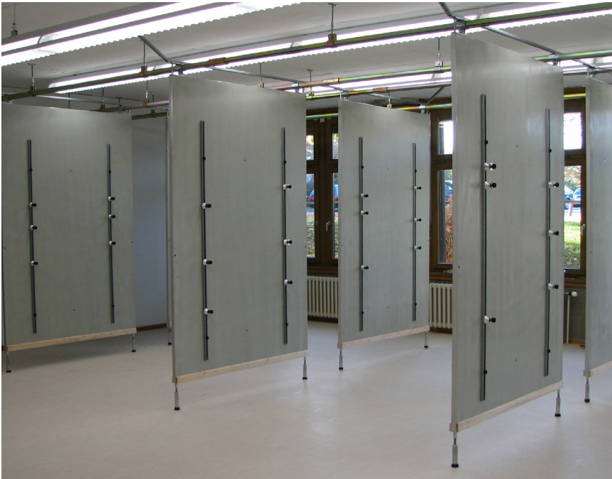
Malerübungstafeln mit Decken-/Schienenaufhängung
