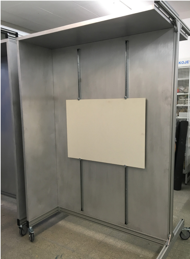
Malerkabine in Alu-Ausführung mit Vorhangschienen zur flexiblen Plattenaufnahme
