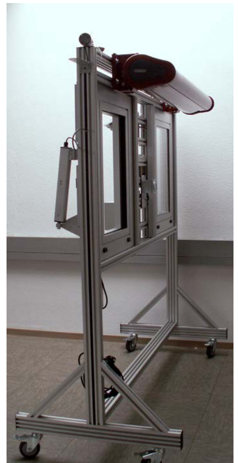
Schulungsstand Automatische Fenstersteuerung mit Witterungssensor und Notzentrale, ergänzt durch ein Dreh-, Kippfenster zur Montage- und Serviceübungen. Rückseitig ist eine elektrische Markise mit Wettersensor montiert.
