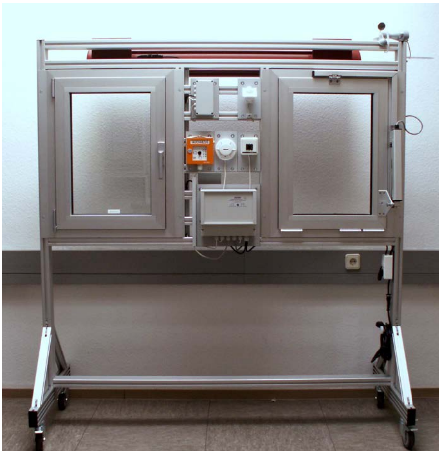
Schulungsstand Automatische Fenstersteuerung mit Witterungssensor und Notzentrale, ergänzt durch ein Dreh-, Kippfenster zur Montage- und Serviceübungen. Rückseitig ist eine elektrische Markise mit Wettersensor montiert.
