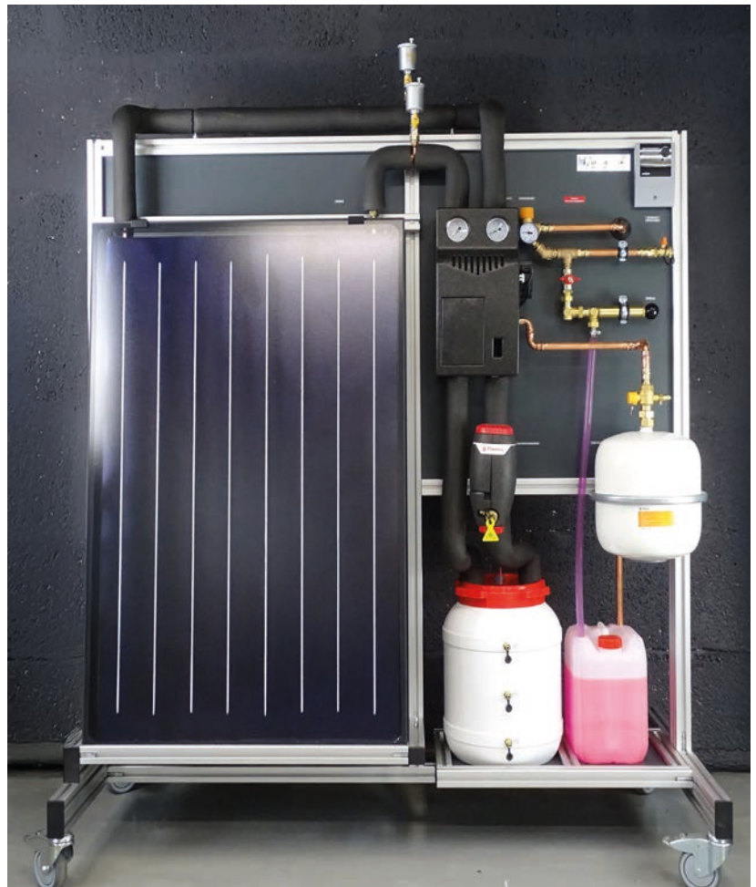
Schulungsstand Solaranlage, Flachkollektor
