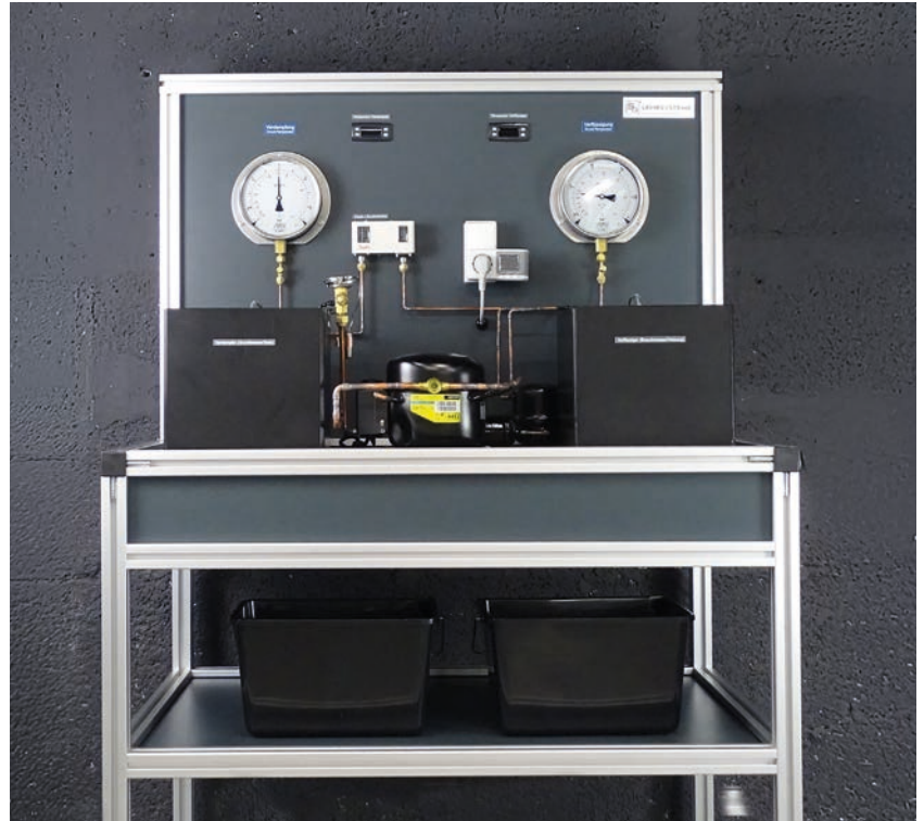
Schulungsstand Wärmepumpe, System Wasser-Wasser
