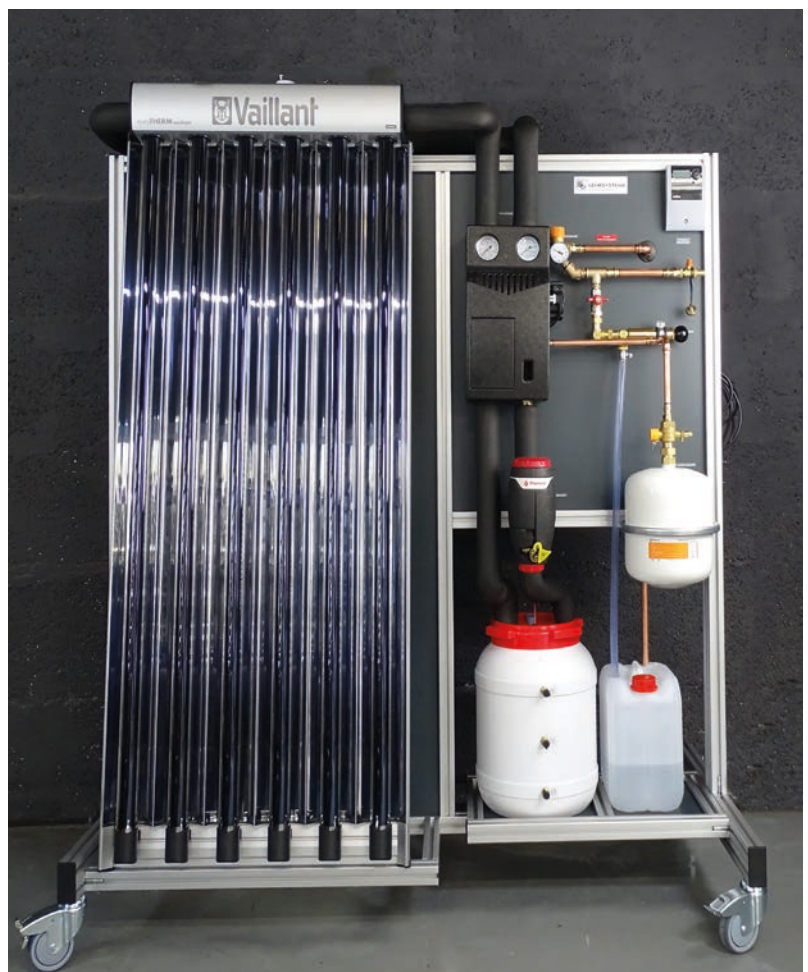
Schulungsstand Solaranlage, Röhrenkollektor
