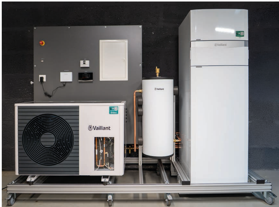
Schulungsstand Wärmepumpe Monoblock mit Brauchwasserspeicher
