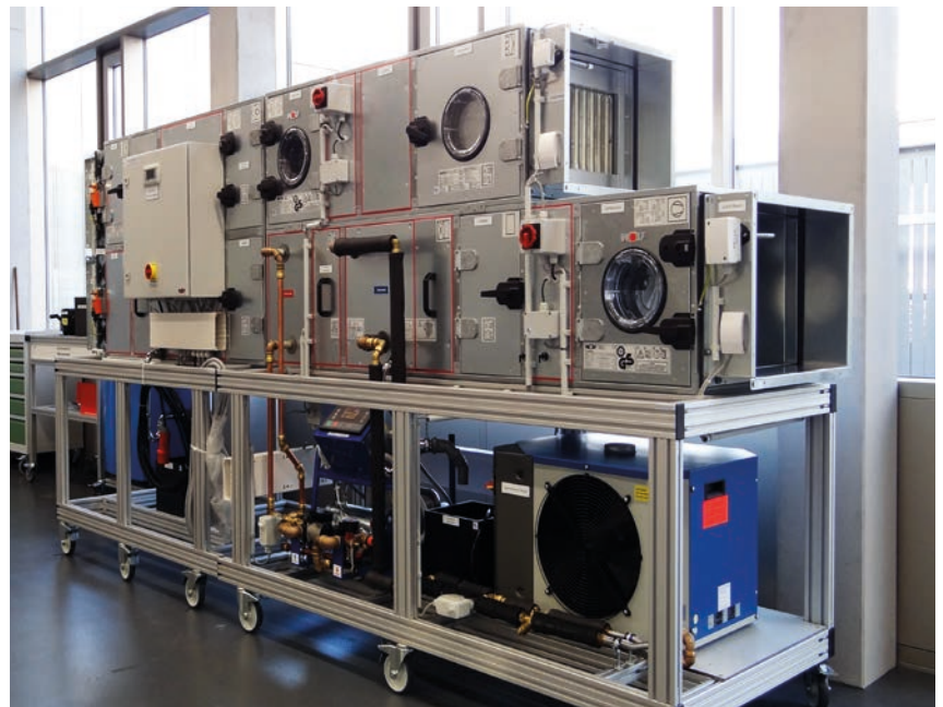
Schulungsstand Klimaanlage, Praxisausführung
