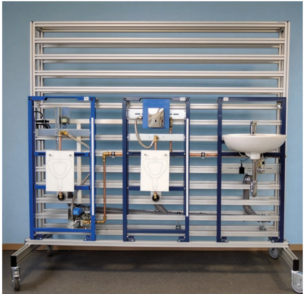
Beispiel: Elektronische Sanitärsteuerung 3 Elemente, hier aufgebaut auf einem Schienen-Wagen mit 2m Breite Art. Nr. 571730-20
