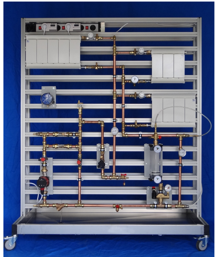
Modulsatz Heizungstechnik aufgebaut auf dem Versuchs- und Montagewagen 571730
