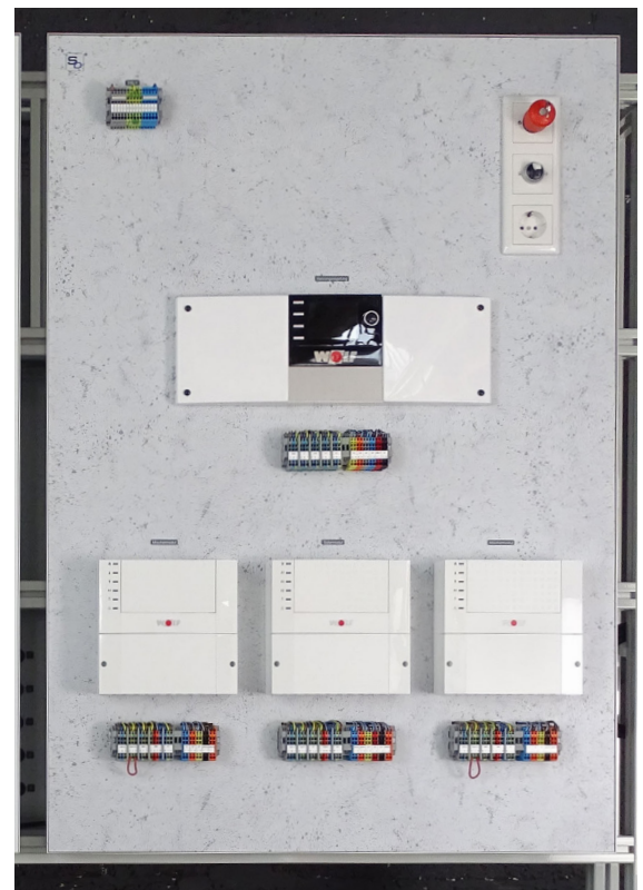
Wolf Komponenten mit ausgeführten Steckklemmen
