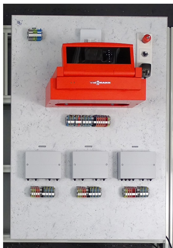
Viessmann Komponenten mit ausgeführten Steckklemmen
