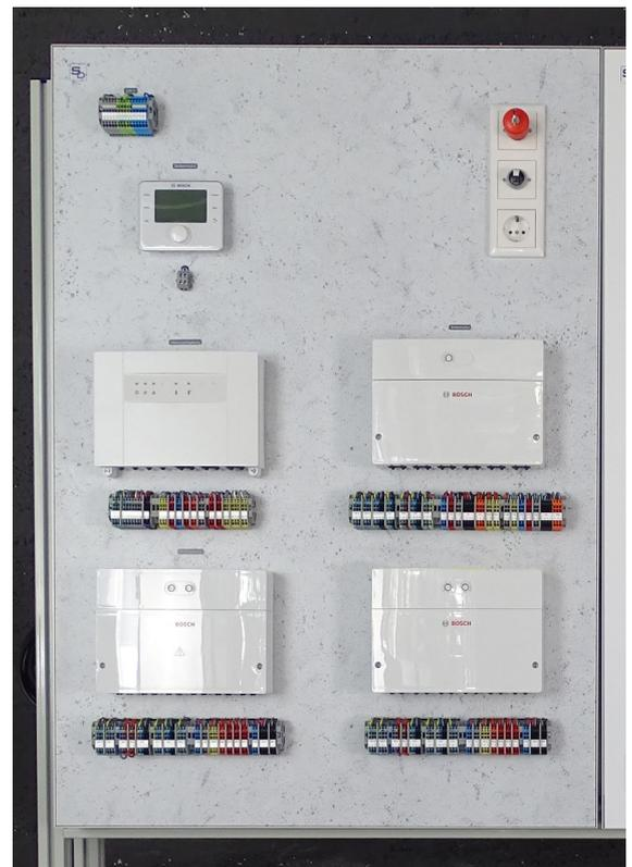
Bosch/Junkers Komponenten mit ausgeführten Steckklemmen
