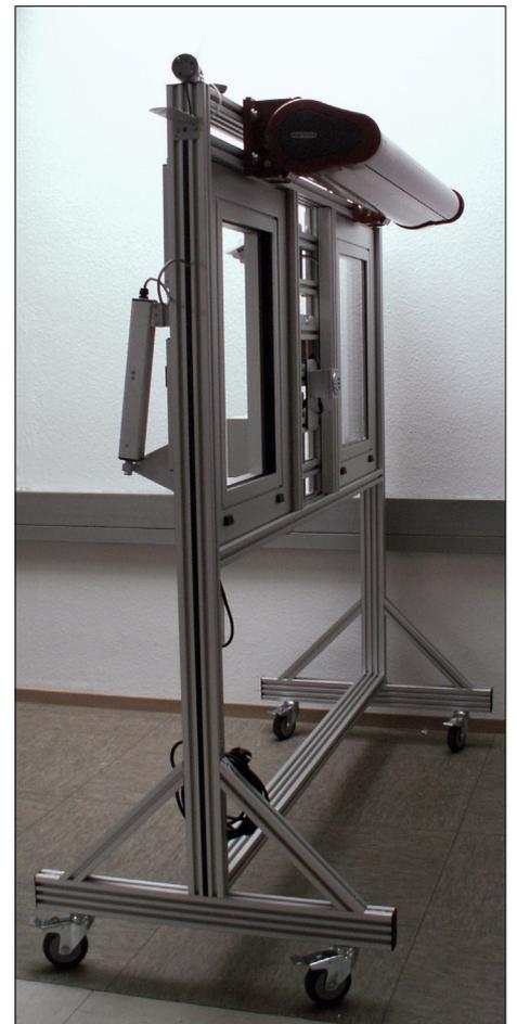
Schulungsstand Automatische Fenstersteuerung mit Witterungssensor und Notzentrale, ergänzt durch ein Dreh-, Kippfenster zur Montage- und Serviceübungen. Rückseitig ist eine elektrische Markise mit Wettersensor montiert.
