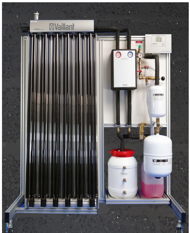
Schulungsstand Solaranlage, Röhrenkollektor
