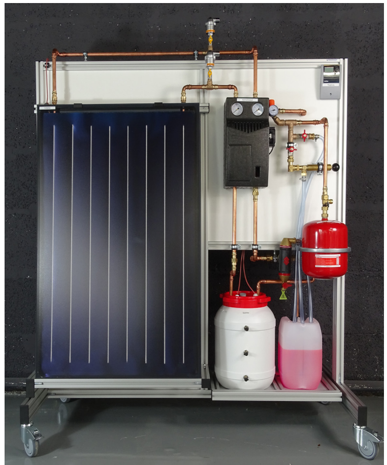
Schulungsstand Solaranlage, Flachkollektor
