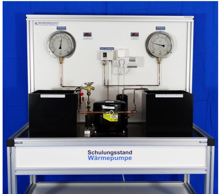
Schulungsstand Wärmepumpe, System Wasser-Wasser
